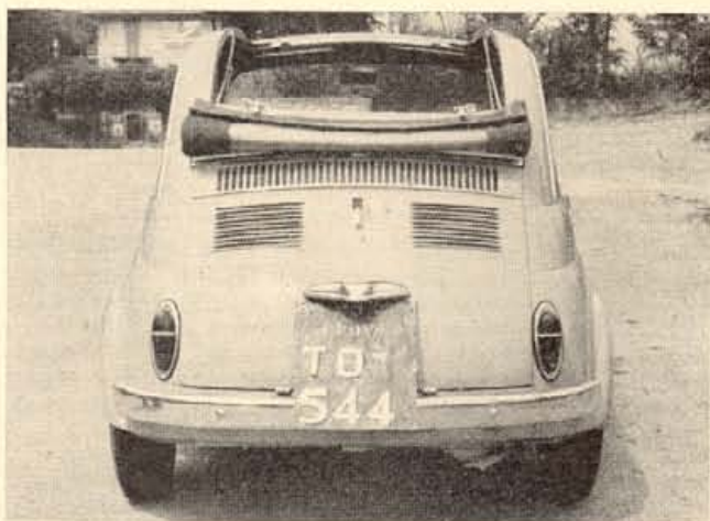
Das Klappdach ist serienmäßig. Die Motorluft wird von den Schlitzen über dem hinteren Deckel angesaugt. Die Negativ-Stellung der Hinterräder ist sehr schwach, sie federn bei Belastung nach oben hin, positiv aus. Deutlich sichtbar die sehr breite Spur.
